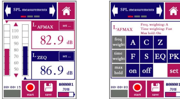
Obrazovka SPL measurements počas merania (vľavo) a so zobrazenou nastavovacou klávesnicou (vpravo)
