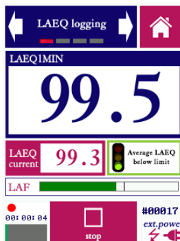
Modul LAEQ zobrazujúci pohyblivú hodnotu LAEQ v intervale 15 minút
